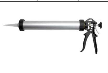
После полного высыхания штукатурки Baumit MVR Uni (в заранее выполненных горизонтальных деформационных швах шириной 20 мм), деформационные шви заполнить полеуретановым герметиком при помощи монтажного пистолета.
